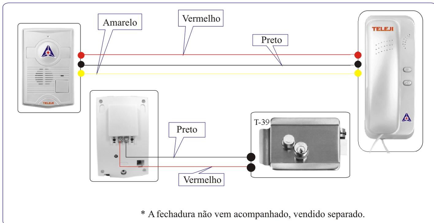
Para distâncias de até 40 m utilizar fios com seção de 0,5 mm, de 40 a 80 m utilizar fios com seção de 1 mm. Para ligar a fechadura elétrica (opcional), utilizar um cabo flexível de seção mínima de 1 mm<sup>2</sup> (18 AWG) Não vem com a fechadura elétrica será necessário adquirir separadamente a fechadura de 12V Ao instalar as fiações tomar o maior cuidado para não inverter os fios.
