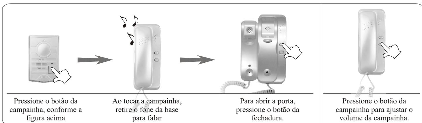
Para abrir a porta com o botão da fechadura é necessário que tenha a fechadura de 12 V instalado. A fechadura elétrica não vem acompanhado, vendido a parte.
